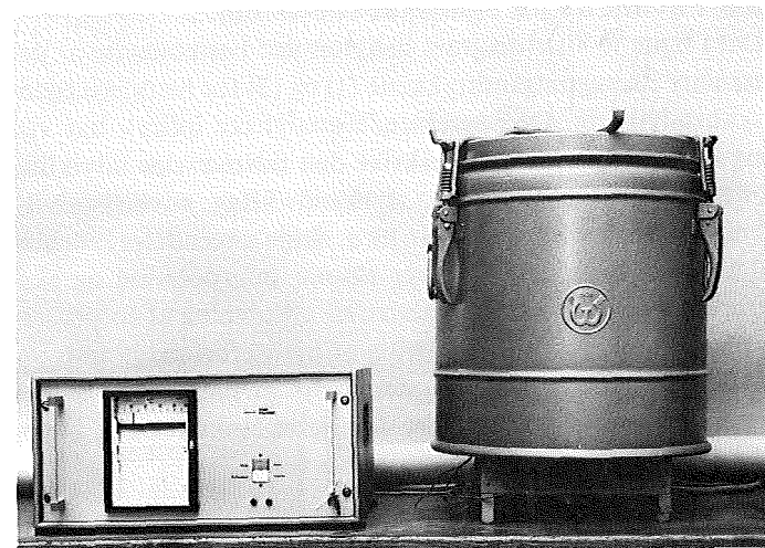
Figur 13. Adiabatisk kalorimeter type Tonindustrie 6010 til bestemmelse af betonens varmeudvikling. Ved måling benyttes en betonprøve på 4-5 liter.
