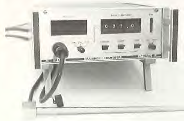
Hærdningsmåleren MA-10, i praksis ofte kaldet Maturity Compu- ter, monteret med langføler. Føleren anbringes i den udstøbte beton. Temperaturen registreres i spidsen af føleren med korte tidsinterval- ler, hvorefter modenheden løbende beregnes og vises på instrumen- tets display.
